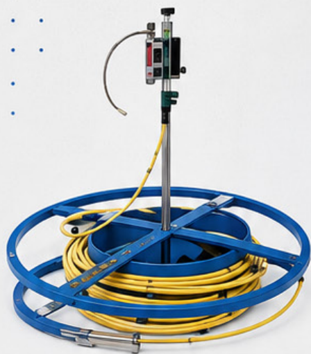
SENSORES DE RECALQUE
