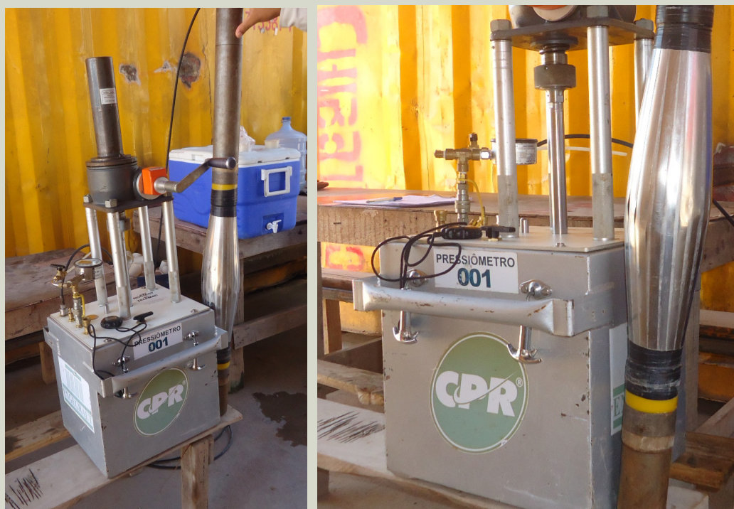
Fig. 6 - Pressiómetro de campo utilizado na investigação geotécnica. O ensaio pressiométrico fornece diretamente parâmetros de deformabilidade, rigidez e resistência in situ, permitindo caracterizar o comportamento tensão-deformação dos solos moles com maior representatividade do que ensaios convencionais. Esses parâmetros são fundamentais para o dimensionamento de técnicas de melhoramento do terreno, para a calibração de modelos numéricos e para a avaliação do desempenho de obras executadas sobre depósitos compressíveis.
