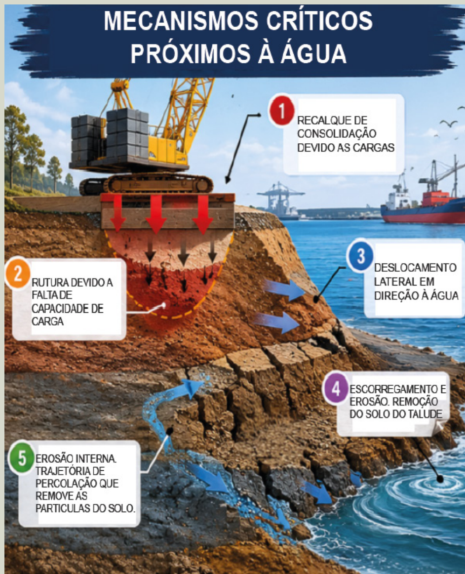
Fig. 3 - A proximidade da água altera o mecanismo que governa o processo de expansão/ retração do solo do talude costeiro, interferindo em sua resistência, recalque, estabilidade, deformabilidade e erosão.
