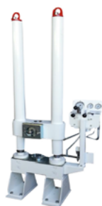
4.688.020 - Sistema hidráulico para realização de ensaio CPT em diversos tipos de Solos
