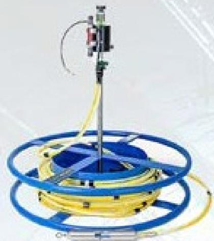
SENSORES DE RECALQUE
