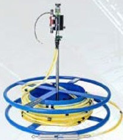
SENSORES DE RECALQUE
