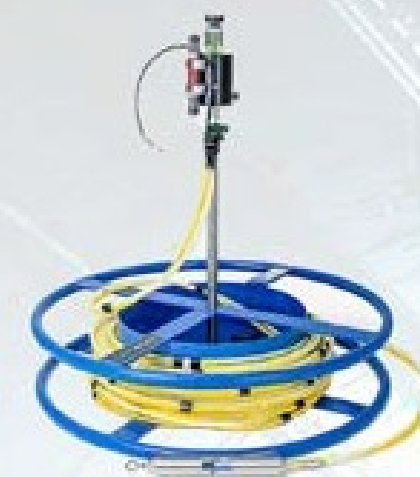
SENSORES DE RECALQUE
