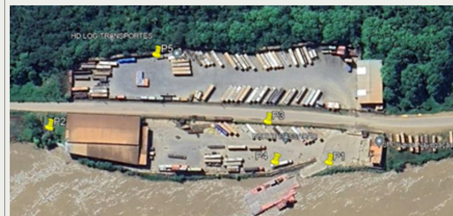
Figura 6 - Vista superior da área portuária, evidenciando sua estreita plataforma, motivada por ruturas anteriores.
