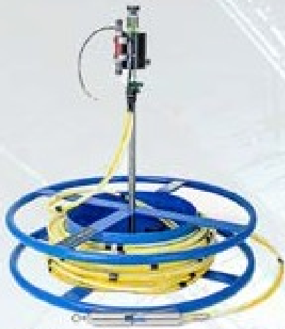
SENSORES DE RECALQUE
