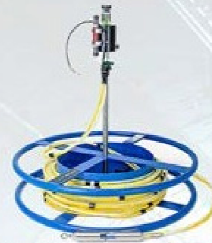
SENSORES DE RECALQUE
