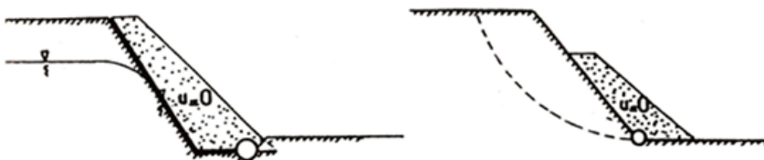
Figura-8- cortes com bermas drenantes
