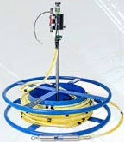
SENSORES DE RECALQUE
