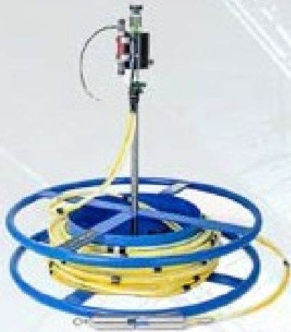
SENSORES DE RECALQUE
