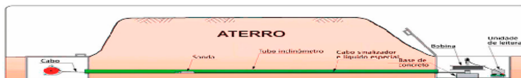
Instalação do medidor do perfil de recalques
