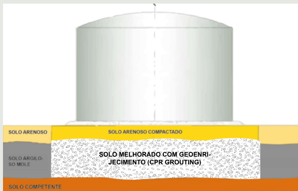
Fig. 4 - O solo melhorado para construção de um tanque. Resistência e rigidez elevadas, específicas para cada projeto. A homogeneização do solo é uma característica importante.
