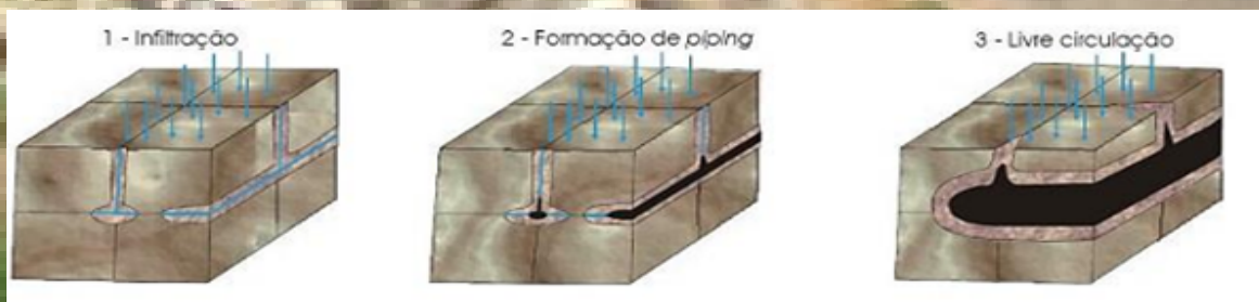
Figura 1 - Modelo de formação de cavidades por arenização e pipping.
