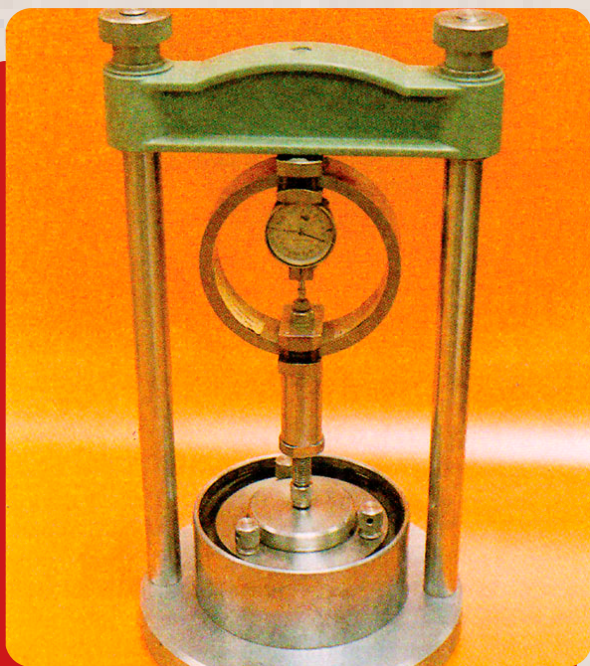
Figura 5 - Aparato de Lambe para caracterizar a expansibilidade do solo.
