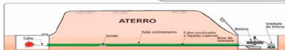
Instalação do medidor do perfil de recalques
