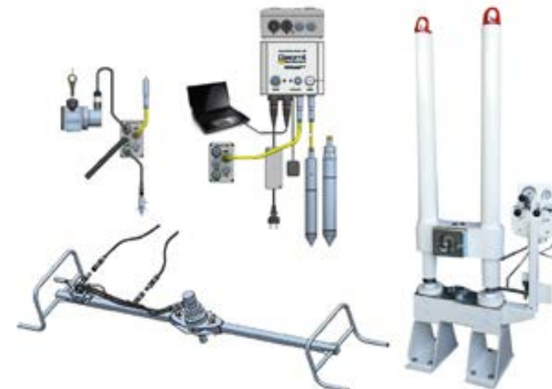
4.688.020 - Sistema hidráulico para realização de ensaio CPT em diversos tipos de Solos
