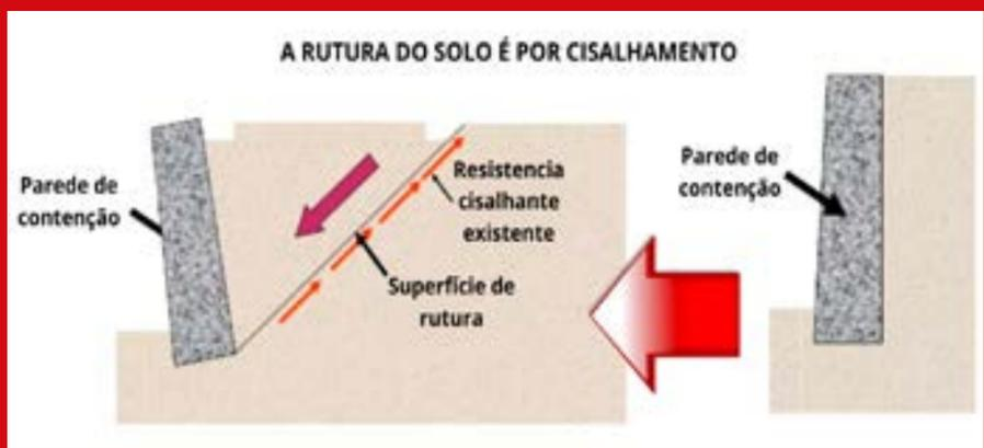
Figura 5 - Na rutura, as tensões cisalhantes, ao longo da superfície de rutura, encontram a resistência do solo.
