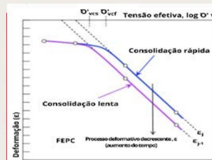
Figura 21 - Relação entre tensão x deformação FEPC, submetido a aumentos no carregamento, mas com diferentes taxas deformativas.  $\sigma'_v$  são as tensões verticais efetivas.
