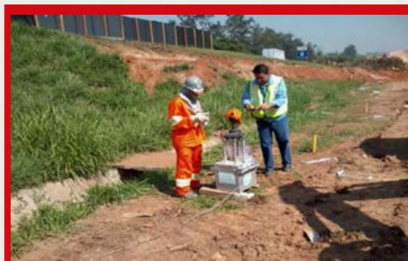
Figura 22 - Verificação da resistência e rigidez do solo mole com pressiómetro, imediatamente antes do melhoramento do solo.
