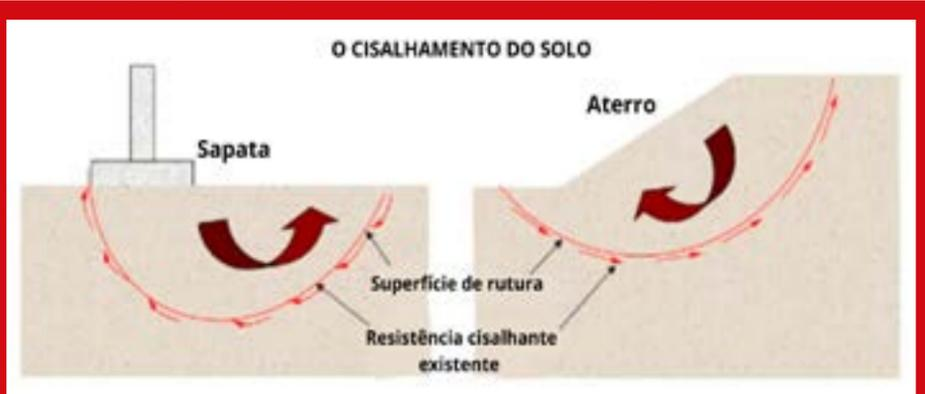
Figura 6 - Na rutura, as tensões cisalhantes, ao longo da superfície de rutura, encontram a resistência do solo.
