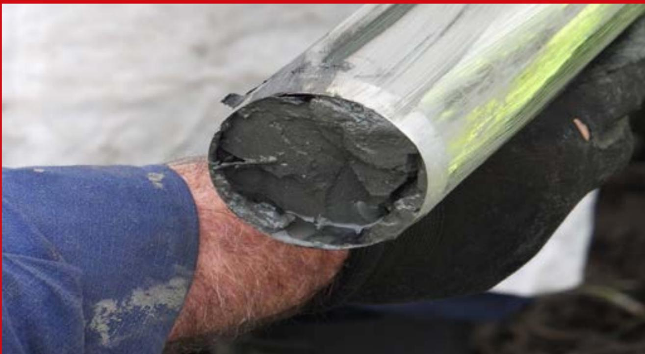
Figura 17: A amostragem, de solos moles, com penetração de pistão pneumático é uma excelente alternativa para se evitar o amolgamento. Utiliza-se tubo com diâmetro 63 e 75mm e com 80cm de comprimento.
