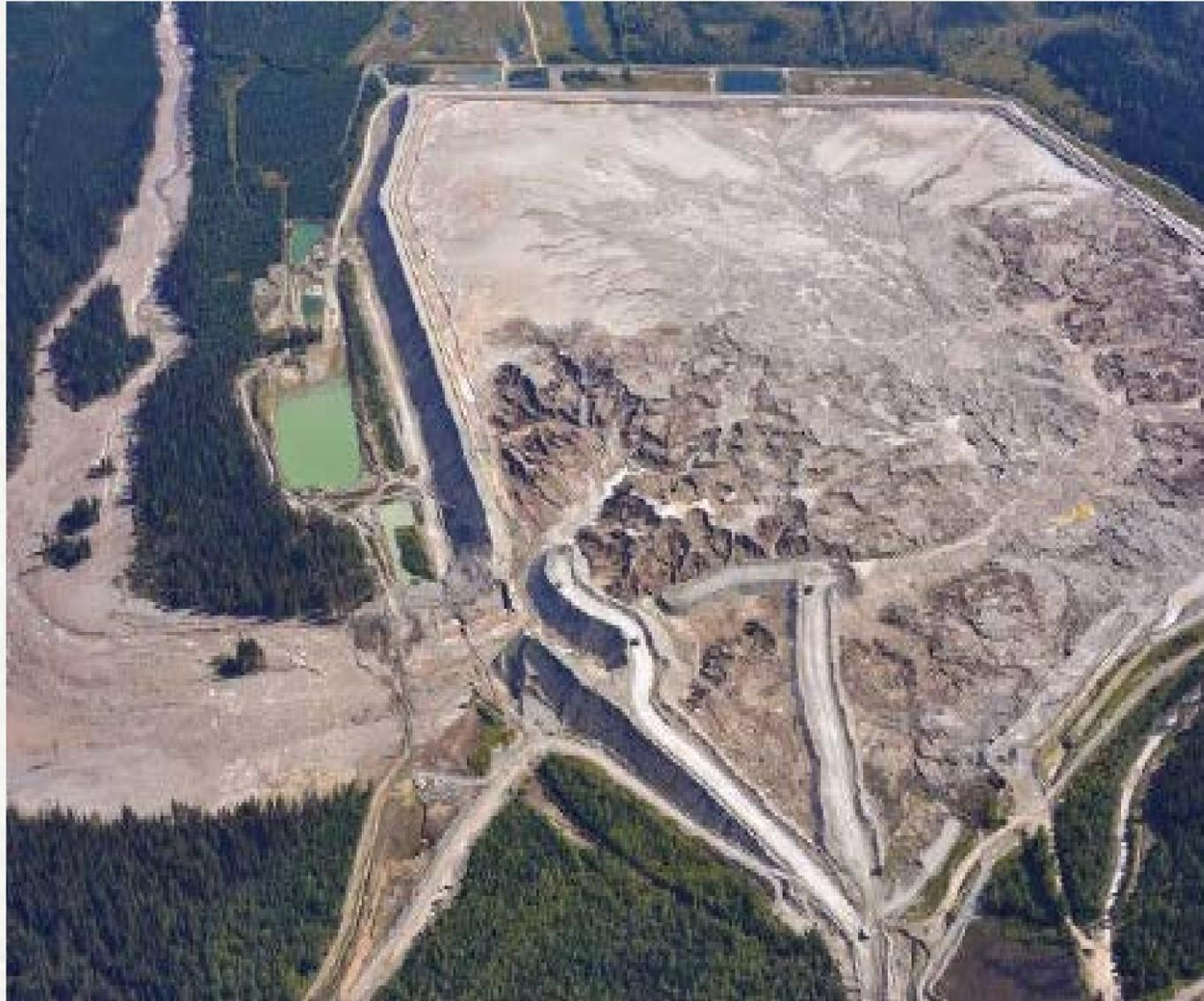
Figura 7: Rompimento de barragem de rejeitos.
