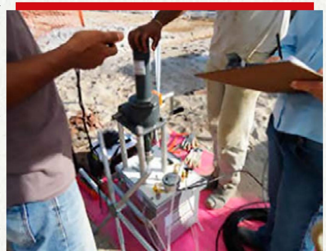
Figura 8: Certificação do melhoramento do solo com pressiometro.
