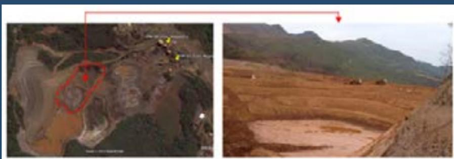
Avanço da lavra com o rebaixamento do nível d'água e formação de taludes.
