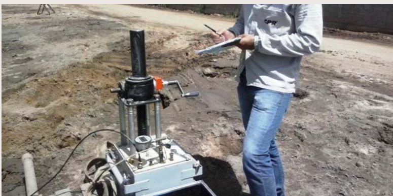
Detalhes do ensaio pressiométrico.
