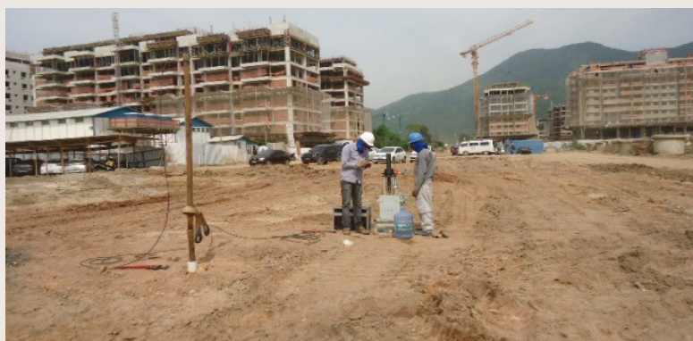
Ensaio pressiométricos, para certificar a evolução da resistência e rigidez do solo melhorado
