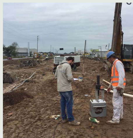
Figura 2: Testes pressiométricos para avaliação da rigidez e da resistência após o melhoramento do solo.
