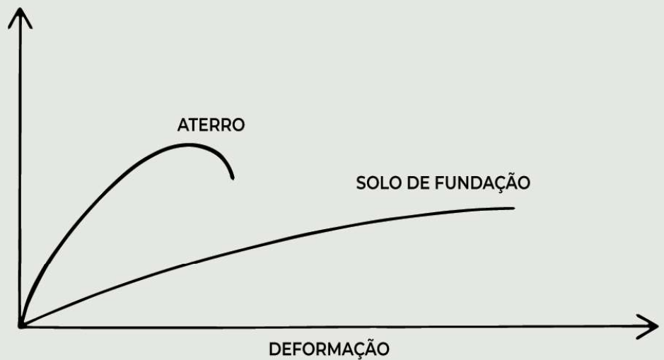
Figura 5 Exemplo de incompatibilidade tensão-deformação
