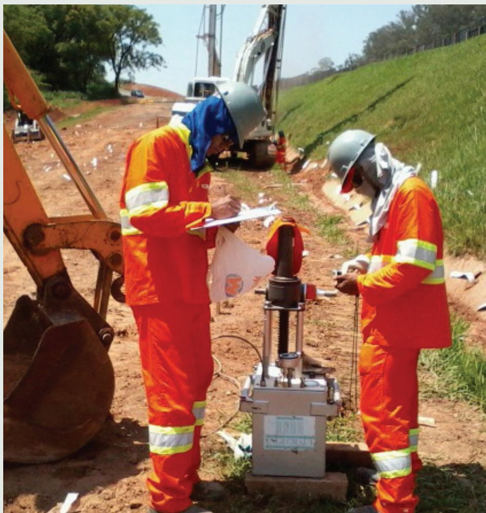
Figura 10 - Análise pressiométrica para análise do solo na condição original. Ensaios penetrométricos (SPT, CPTu e palheta) via rutura, não certificam qualquer melhoramento de solos, já que só avaliam o componente solo. Ensaios por deformação, tipo pressiométrico e tomografia do solo com imagem, conseguem analisar os dois componentes, de forma simultânea, do solo composto melhorado.
