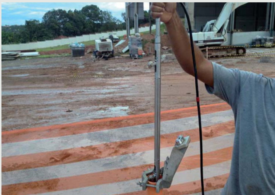
Figura 17 - A utilização de inclinômetros torna-se necessário para informar a movimentação horizontal das camadas do solo. Na foto a introdução do torpedo dentro da tubulação especial.
