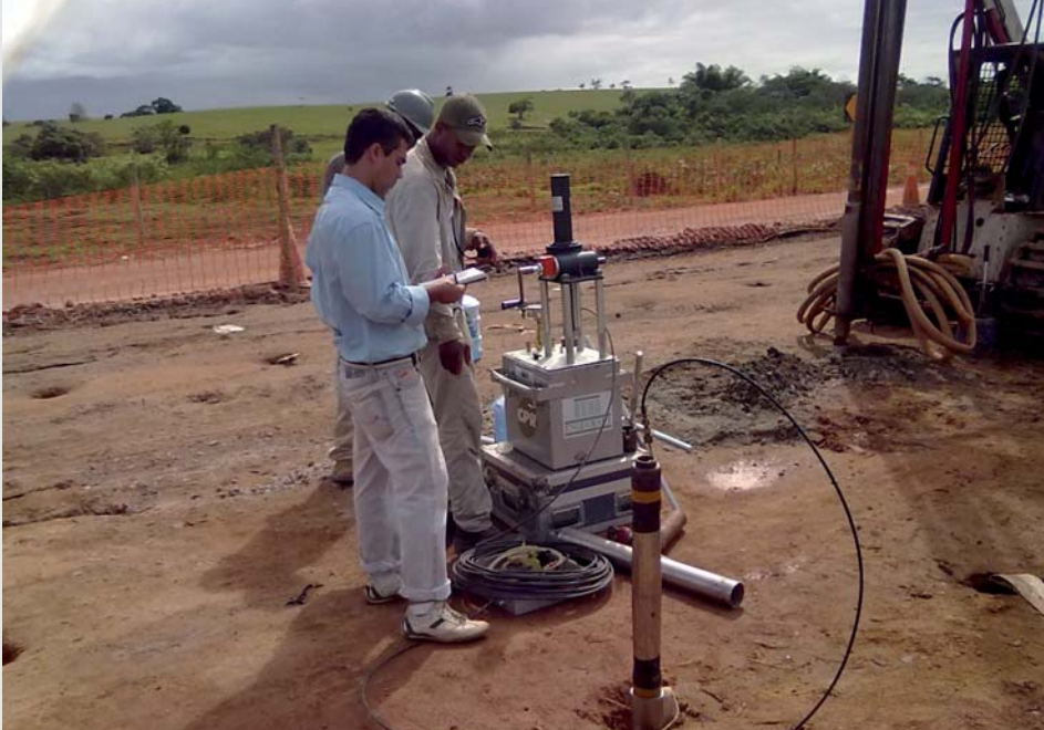
Figura 5 - Análises pressiométricas para aferir o nível de rigidez do solo melhorado em relação ao maciço da antiga rodovia.
