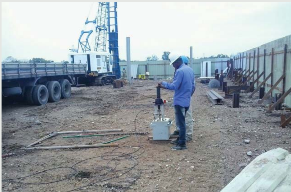
Figura 7 - ...assegurado com análise pressiométrica e tomográfica do solo.
